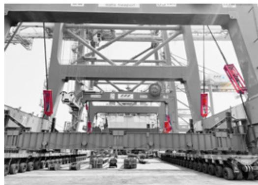
tonnellate ad asse, sono stati inizialmente assemblati e preparati in modo da poter gestire il carico delle gru. Sono state assemblate quattro linee di 22 assi ciascuna, divise in due convogli per mezzo di distanziali (travi di trasporto) da 900 mm opportunamente posizionati, allineandoli cioè tra il 2°, 6°, 17°, 21° asse. Gli SPMT sono stati assemblati in banchina per mezzo di idonee autogru. (foto 6)
