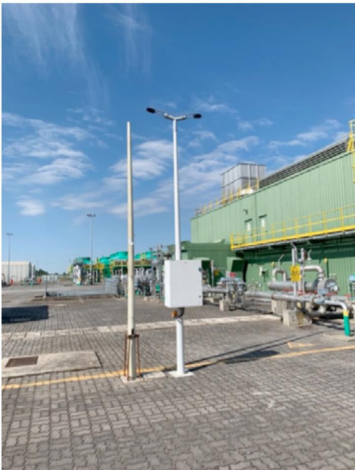
Figura 6 - Esempio di sistema fonometrico installato su palo
