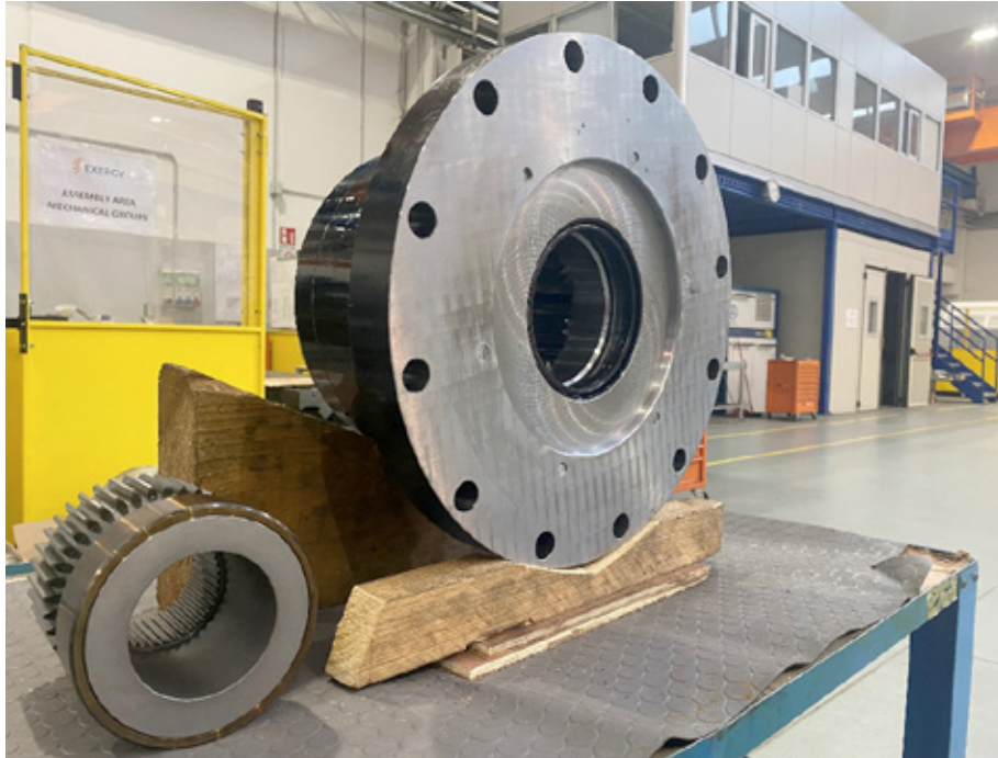
Figura 2 – Riduttore di giri progettato da Exergy nel progetto TechFast
