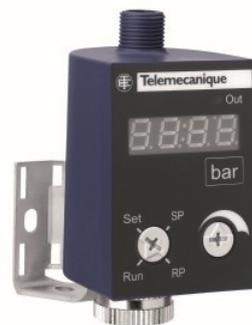
visuale. Alcune caratteristiche tecniche sono: alimentazione elettrica 24 V DC; valori display da -14.5...0 a 0...6000 con 27 range di visualizzazione selezionabili; output digitale PNP o NPN, programmabile NO/NC e output analogico 4...20 mA; ingresso connessione elettrica con connettore M12 femmina, 4 pin e in uscita con connettore M12 maschio, 4 pin; grado di protezione IP65, IP6 e IP69K; temperatura di operatività da -2 a 70 °C; certificazioni: cULus basata su UL 508.
