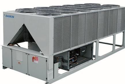
La nuova serie, proposta in tre categorie di efficienza (Silver, Gold e Platinum, ciascuna in 14 taglie), è equipaggiata con compressore/circuito singolo con capacità di raffreddamento tra 170 e 365 kW, o doppio compressore/circuito per potenze maggiori (340 - 710 kW). Ogni circuito dispone di economizzatore. Per la versione Platinum la produzione di acqua refrigerata è garantita tra -8 e +15 °C con temperatura esterna minima di -18 °C e massima di +51 °C.
