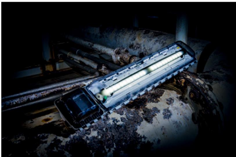
Le armature illuminanti d'emergenza 6009/1 sono disponibili in due versioni : la più corta con una potenza di 28W fornisce un flusso luminoso di 2440 lm, la versione più lunga con potenza di 52W raggiunge i 4980 lm. Anche in funzione d'emergenza, il 30% o 21% di questi valori garantiscono una visibilità adeguata.
