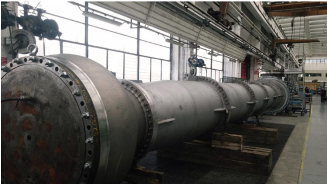
Fig. 4 - Pompa acqua mare "main" in fase di pressatura idraulica presso l'officina di TMP
