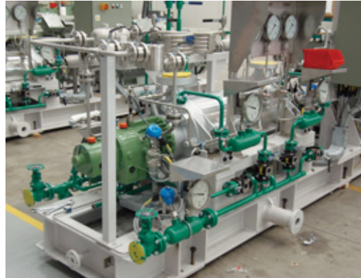
Pompa TMP per servizio alimento caldaia per la centrale elettrica PP10 della Saudi Electricity Company soggetta dell'accordo di assemblaggio locale
