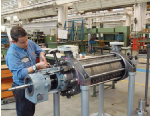
Pompa TMP per servizio alimento caldaia per la centrale elettrica PP10 della Saudi Electricity Company soggetta dell'accordo di assemblaggio locale
