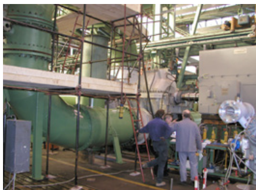
Pompa TMP per servizio raffreddamento condensatore per centrali elettriche Iraniane soggette dell'accordo di co-manufacturing con trasferimento di tecnologia
