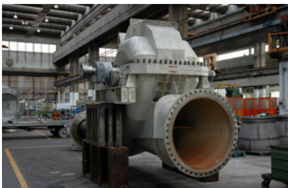
Pompa TMP per servizio raffreddamento condensatore per centrali elettriche Iraniane soggette dell'accordo di co-manufacturing con trasferimento di tecnologia
