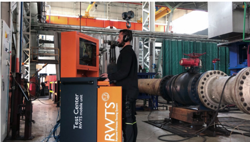
Un operatore del Centro Prove prepara una prova funzionale presenziata in remoto dal cliente tramite apposita attrezzatura
