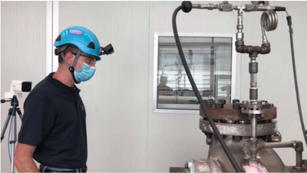
Sistema di web cam fissa e mobile (su casco) connesse a Internet, installate in officina di Termomeccanica per la realizzazione di un test idrostatico presenziato dal cliente in remoto
