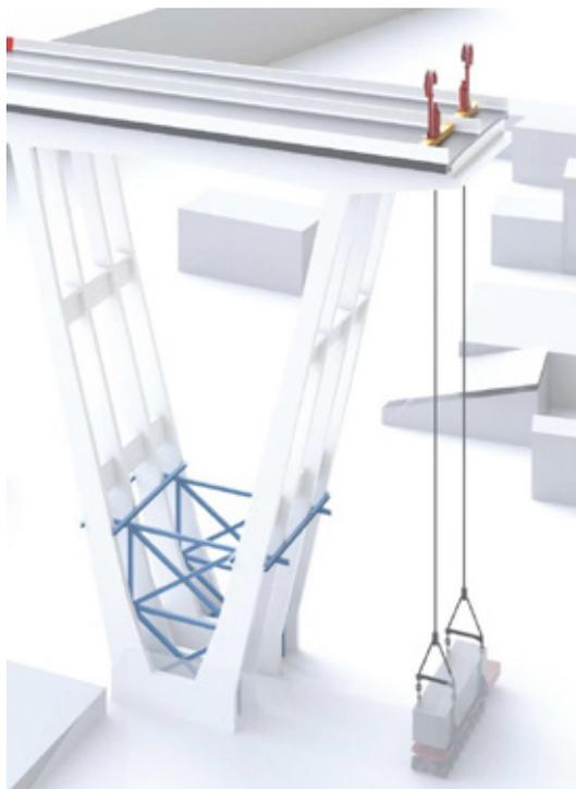
Figura 1 – Sistema di bilanciamento della Pila 8
