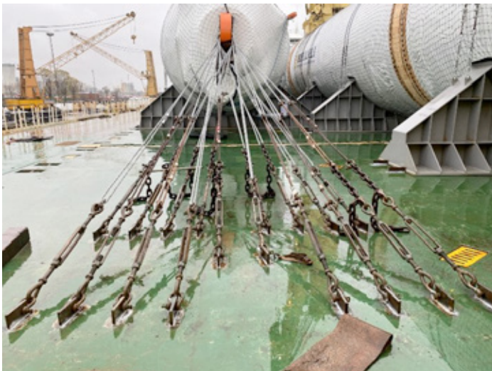
Seafastening longitudinale - lifting lug e gonna
