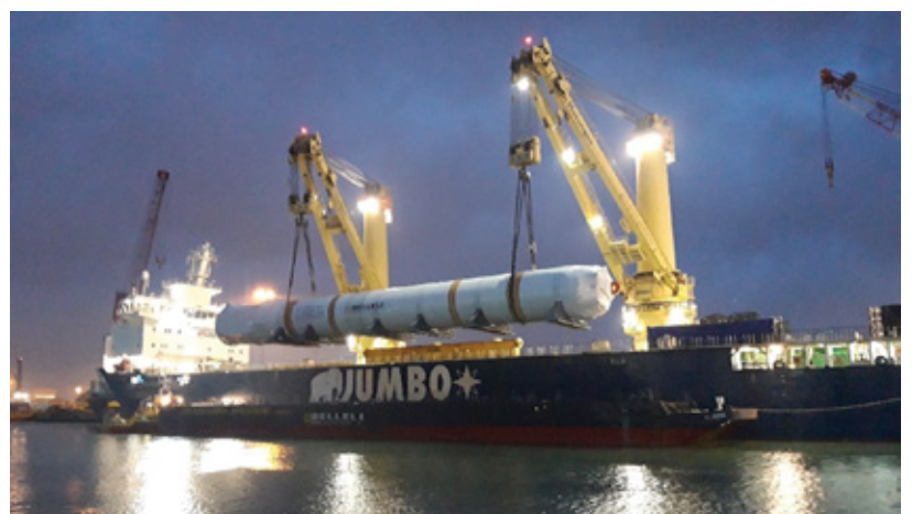
Imbarco con tiro da "port side" con gru "starboard side"
