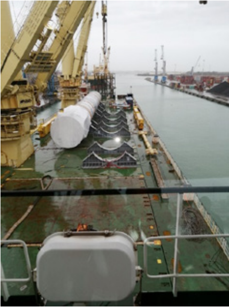
Selle posizionate in coperta per ricevere il secondo reattore e inizio sollevamento da chiatta
