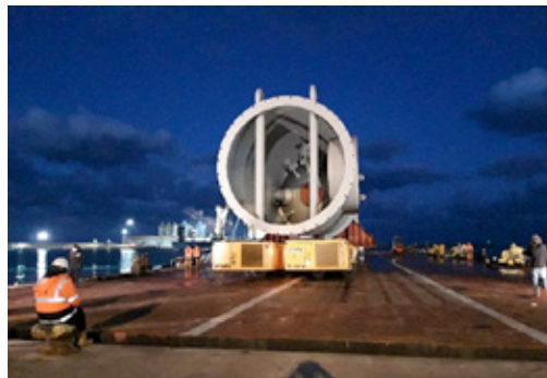
Vari step di traslazione laterale del reattore e relativo ballastaggio - Ortona
