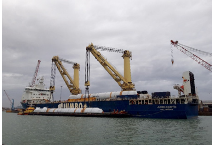
Selle posizionate in coperta per ricevere il secondo reattore e inizio sollevamento da chiatta
