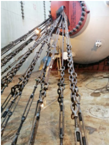
Seafastening longitudinale lifting lug e gonna
