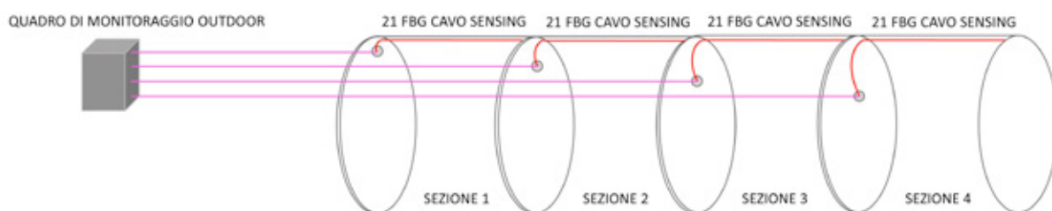
Fig. 4 - Layout del sistema di monitoraggio del Microtunnel
