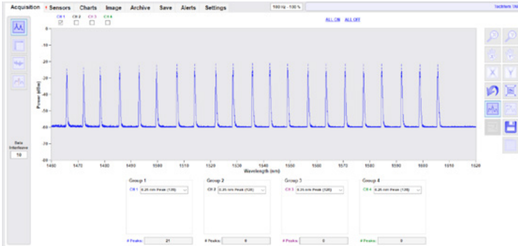
Fig. 8 - Picchi spettrali Bragg Wavelength dei sensori FBG
