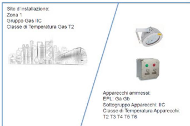
Figura 8 – Esempio di abbinamento per sito d’impianto Zona 1 IIC T2
