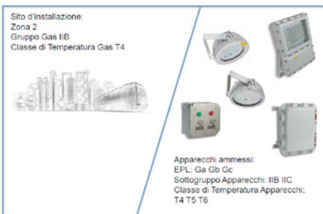
Figura 10 – Esempio di abbinamento per sito d’impianto Zona 2 IIB T4
