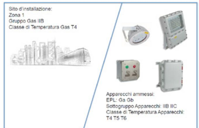
Figura 9 – Esempio di abbinamento per sito d’impianto Zona 1 IIB T4
